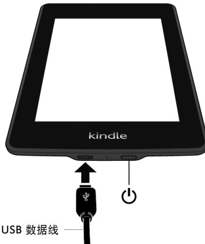
**电源开关：**按下 Kindle 电源开关以打开您的 Kindle。如需关闭 Kindle 屏幕，请按住电源开关 7 秒直至【电源】对话框出现，然后选择【关闭屏幕】。
