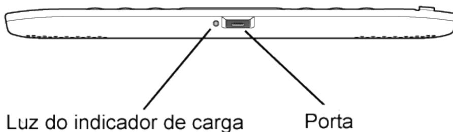
**Microporta USB/energia** — Conecte o cabo que veio com o Kindle à microporta USB/energia e ao adaptador de energia\* do Kindle. Conecte o adaptador a uma tomada elétrica compatível com o padrão dos EUA para carregar a bateria do Kindle. Você também pode carregar o Kindle desconectando o cabo USB do adaptador e conectando-o à porta USB do computador ou ao hub USB alimentado.
